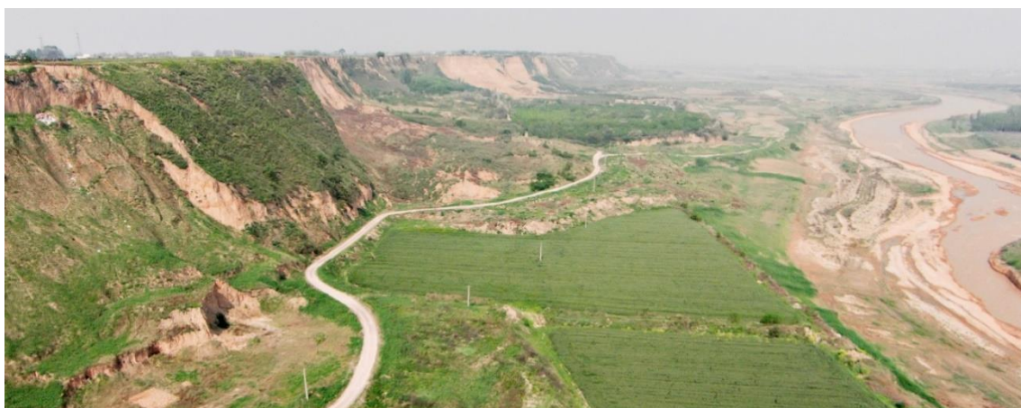
图 8 灌溉在咸阳黄土塬的北缘诱发的滑坡群
